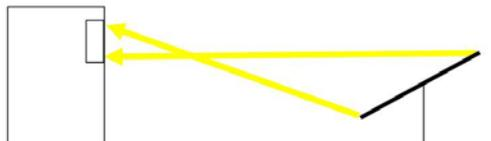
Abbildung 11: Höhenwinkel der Blickpunkte aus Entfernung und Höhendifferenz von Blendpunkt zu Blickpunkt
